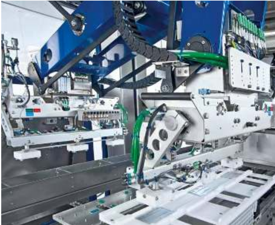
Ein TLM-F2-Roboter legt drei Blister in die Formatplatte eines Transmoduls ein.
